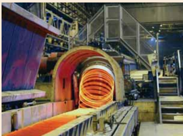
Новий стан 400/200, модернізований із виробництвом катанки до 5,5 мм і кутка 55
