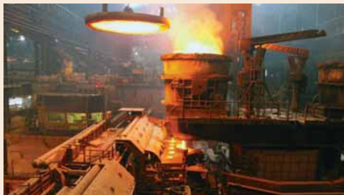
МНЛЗ-3 — сталь-ковш на поворотному стенді
