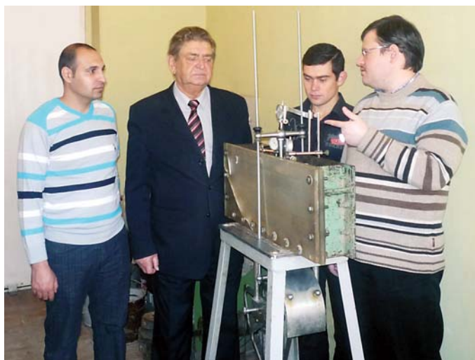
Проведення лоткових випробувань моделі залізничного земляного полотна аспірантом із Йорданії А. М. М. Алхадуром
