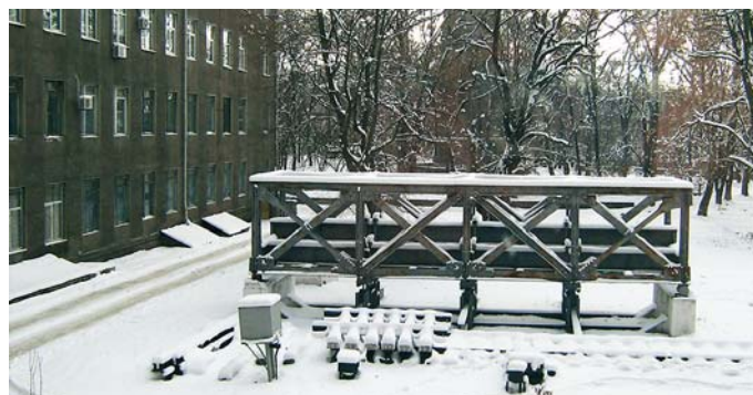
Модель для дослідження роботи елементів прогонової будови, переданої Є. О. Патонем кафедрі в 1931 р.
