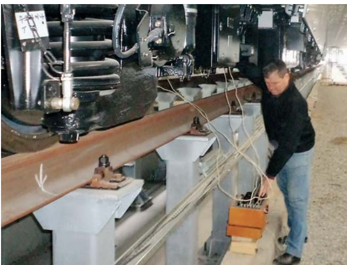
Електротехнічні випробування електропоїзда Hyundai Rotem
