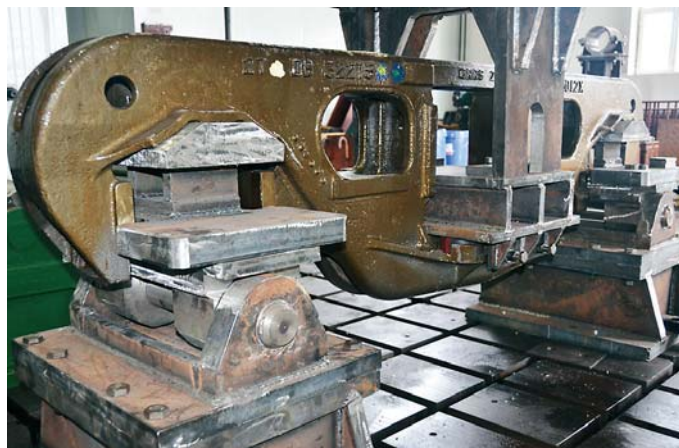
Випробування на опір втомі міцності бічної рами візка для вантажного вагона, м. Цицикар (Китайська Народна Республіка)
