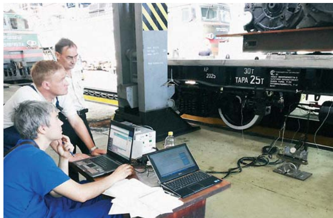
Статичні випробування модернізованих вагонів-платформ, м.Челябінськ (Росія)
