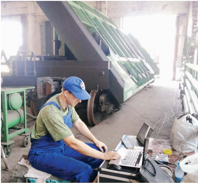
Стационарні випробування вагона-платформи для широколистового прокату, м. Дніпродзержинськ
