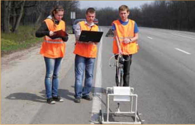
Пересувна лабораторія для використання георадіолокаційних технологій у системі діагностики дорожніх одягів
