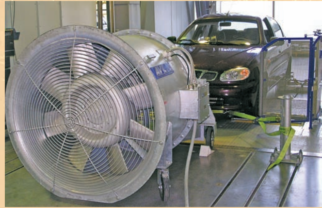
Стендові випробування автомобілів на відповідність Правил ЄЕК ООН 83-04
