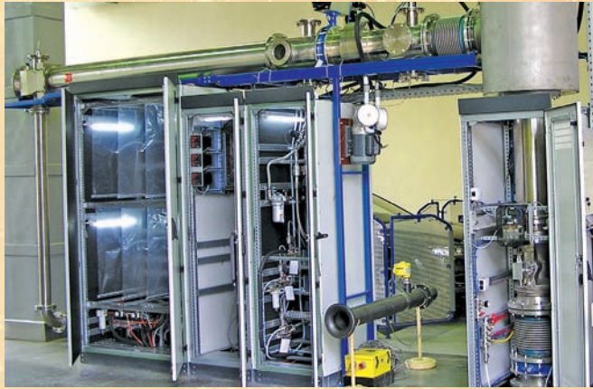
Дослідна повно-поточкова система відбору проб постійного об'єму (CVS) моделі EMMS-CVS-010
